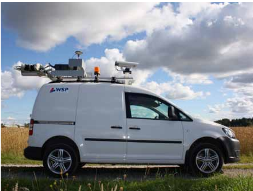
En vanlig arbetsbil utrustas med geotracker för att göra mätningarna.
